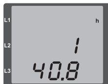
Abb. Messwertanzeige Betriebsstundenzähler
