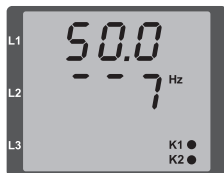
Abb. Anzeige der Netzfrequenz (50.0) und der Drehfeldrichtung
