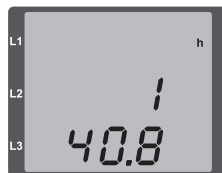
Abb. Messwertanzeige Betriebsstundenzähler
