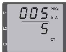
Abb. Programmier-Modus Stromwandler
