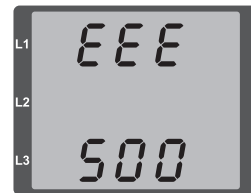
Abb. Warnmeldung mit Nummer 500 (Netzfrequenz)
