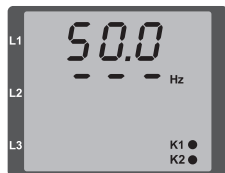
Abb. Keine Drehfeldrichtung feststellbar.
