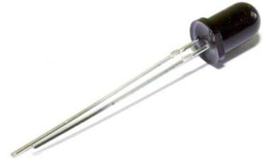
Wenn der Sensor sich einem Feuer nähert, ändert sich der analoge Spannungswert. Mit einem Multimeter lässt sich überprüfen, dass die Spannung bei  $\sim 0.3V$  liegt, wenn sich kein Feuer nähert. Nähert sich ein Feuer, so liegt die Spannung bei  $\sim 1.0V$ . Je höher die Spannung, desto näher das Feuer.
