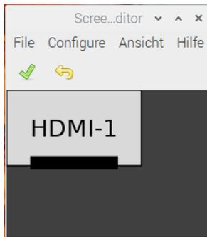
In diesem Fenster gehen Sie dann einfach über **Configure > Screens > HDMI-1 > Drehung** auf die gewünschte Ausrichtung, die Sie für Ihr Display benutzen wollen.
