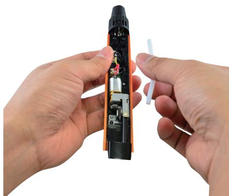
Platzieren Sie das Reinigungswerkzeug im Zuführungspfad und stecken Sie die scharfe Spitze des Werkzeugs in die runde Öffnung an der Oberseite des Einführungspfad.
