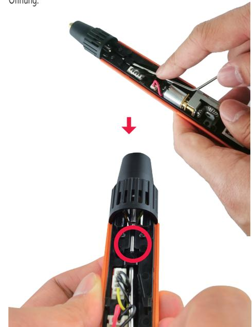
Bewegen Sie das Werkzeug vor und zurück. Materialreste aus dem Extrudermodul können an der Öffnung herausgedrückt werden.
