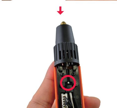
Drücken Sie das Werkzeug sanft, bis es vollständig im Zuführungspfad steckt. Die Werkzeugspitze bewegt sich etwa 1 cm durch die runde Öffnung.
