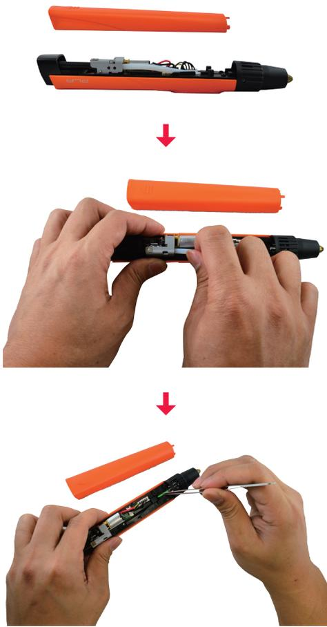
Entfernen Sie Reste im weißen Führungsrohr mit dem Reinigungswerkzeug. Achten Sie darauf, alle Filamentreste aus dem Führungsrohr zu entfernen; bringen Sie die rückseitige Abdeckung wieder an und starten Sie die Zuführung neu.
