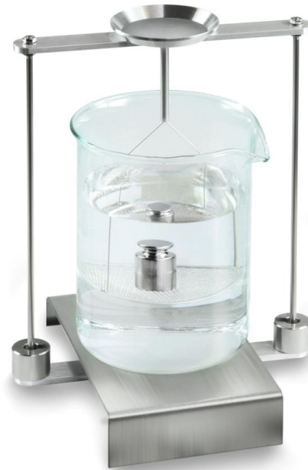
Abb.6: Wägung in Prüfflüssigkeit
