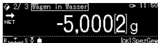
Abb.4: Wägung in Hilfsflüssigkeit
