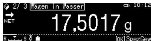
Abb.2: Wägung in Hilfsflüssigkeit
