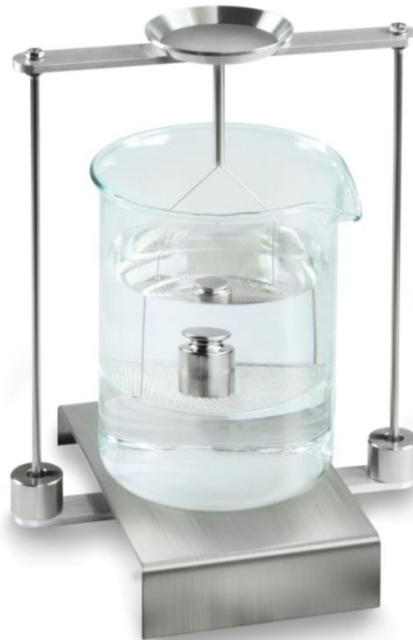
Abb.2: „Wägung in Hilfsflüssigkeit“
