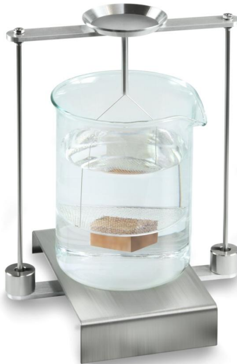
Abb.4: Wägung in Hilfsflüssigkeit
