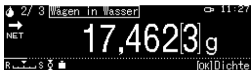
Abb.2: Wägung in Prüfflüssigkeit
