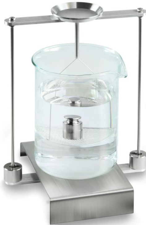
Abb.2: Wägung in Hilfsflüssigkeit
