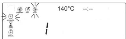
Le profil de chauffage actuellement réglé et le critère de coupure clignote.
