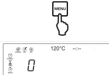
⇒ Nach Drücken der wird die erste Kennziffer <0> angezeigt.
