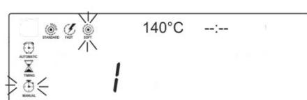
⇒ Mit bestätigen, die aktuell eingestellte Trocknungstemperatur blinkt.
