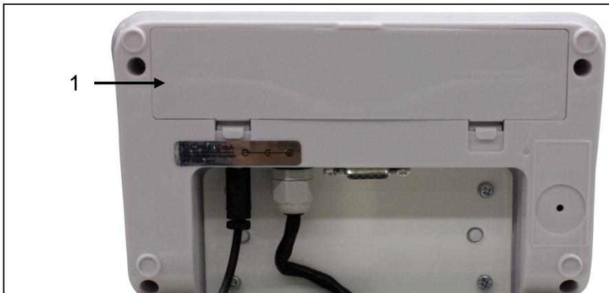
Akkufachdeckel (1) an der Unterseite des Anzeigeräters öffnen und Akku anschließen. Der Akku sollte vor der ersten Benutzung mindestens 12 Stunden geladen werden.
