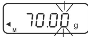
**SET**-Taste drücken und gedrückt halten bis die Anzeige zur Einstellung des unteren Grenzwertes „L.SET“ angezeigt wird. Die aktuelle Einstellung z.B. „70.00 g“ blinkt.
