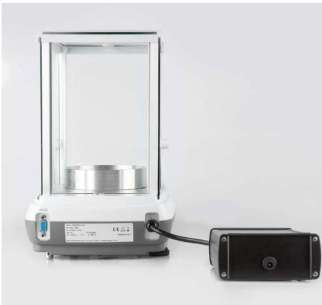
Waage mit der Elektronikbox verbinden.
