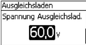
5. ▾ drücken, um zu Spannung Ausgleichslad. zu wechseln.
