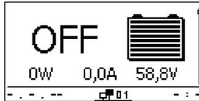
Abb. 7: Display nach dem Einschalten der externen Batteriesicherung
