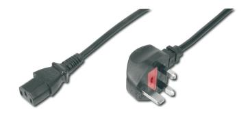
Netzanschlusskabel, UK Stecker, 90ø gewinkel - C13 St/Bu, 1.8m, H05VV-F3G 0,75qmm, Sicherung 5A, sw
