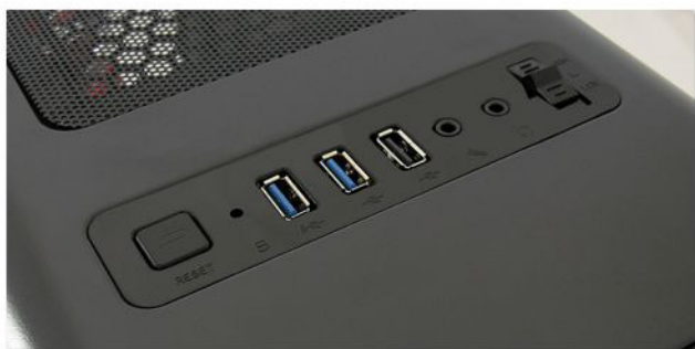
- I/O-Panel mit: 2x USB 3.0-Port, 1x USB 2.0-Port, HD Audio, Lüftersteuerung
