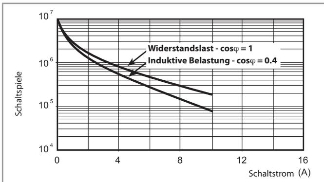
**H 40 - Gleichstromschaltvermögen bei DC1 - Belastung**
