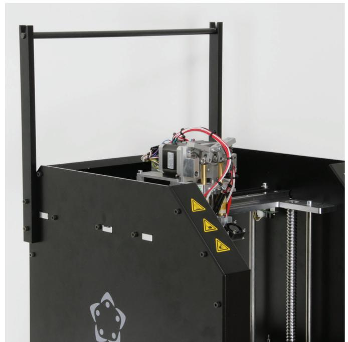
Zum Abschluss legen Sie die Welle für den Filament-Halter oben in die Führungen ein.
