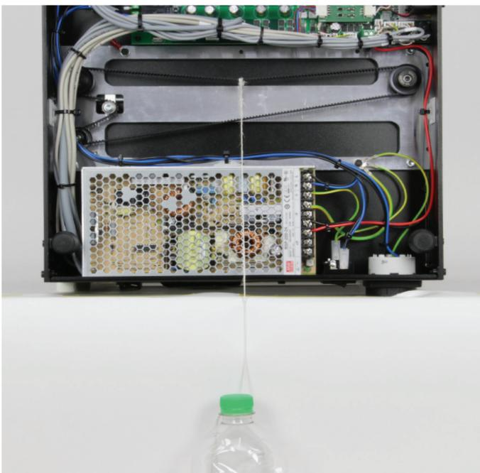
Kippen Sie den Drucker nahe einer Tischkante auf seine Rückseite und entfernen Sie das Bodenblech. Befestigen Sie das Gewicht mit der Schnur in der Mitte am nun oben liegenden Teil des Zahnriemens für die Z-Richtung.
