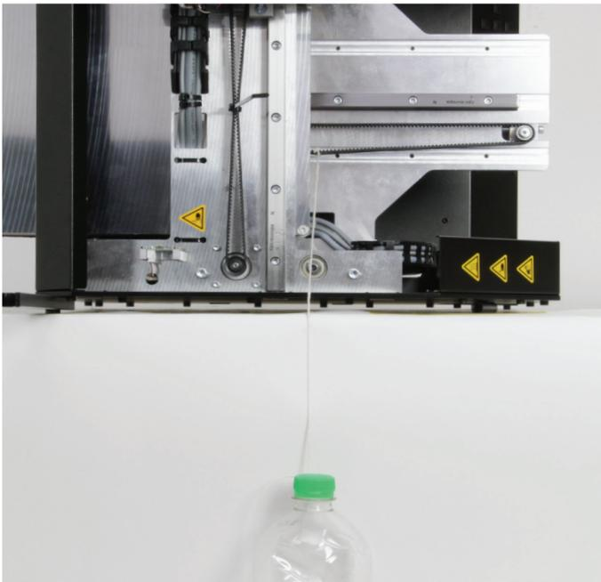
Kippen Sie den Drucker nahe einer Tischkante auf seine linke Seite und befestigen Sie das Gewicht mit der Schnur am nun unten liegenden Teil des Zahnriemens für die Y-Richtung.
