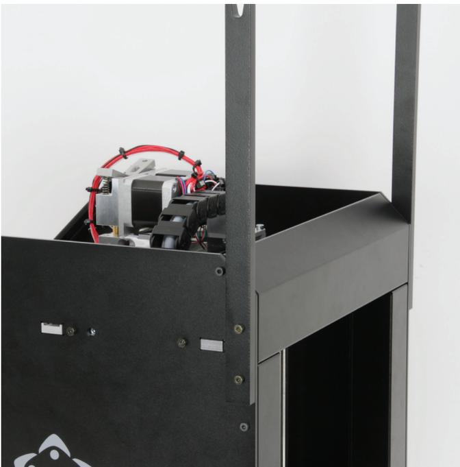
Entfernen Sie die Sicherungsschraube und klappen Sie die rückseitige Kopfblende wieder nach unten. Montieren Sie im Anschluss zuerst die zuvor wieder entfernte Sicherungsschraube im Montageloch und danach den Filament-Halter auf der linken Seite (aus der Rückansicht).
