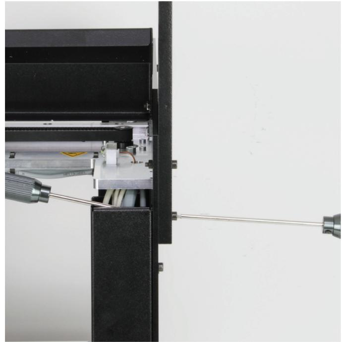
Die obere Schraube befestigen Sie mit einer Mutter M4 handfest. Sie dient momentan lediglich zur Sicherung. Befestigen Sie die untere Halte-Schraube des Filament-Halters und ziehen diese auch gleich fest. Am einfachsten montieren Sie die Mutter mit einem Finger und ziehen Sie anschließend mit einem Außensechskant-Steckschlüssel fest.
