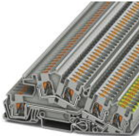
Installationsschutzleiterklemme, Push-in-Anschluss, Querschnitt: 0,2 mm 2 - 6 mm 2 , AWG: 24 - 10, Breite: 6,2 mm, Farbe: grau, Montageart: NS 35/7,5, NS 35/15
