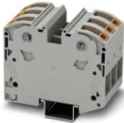
Hochstromklemme, Anschlussart: Power-Turn-Anschluss, Anzahl der Anschlüsse: 6, Querschnitt: 2,5 mm 2 - 35 mm 2 , AWG: 12 - 2, Breite: 48 mm, Farbe: grau, Montageart: NS 35/15
