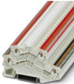
Doppelstockklemme, für KNX-Bus in der Gebäudeinstallation, Anschlussart: Push-in-Anschluss, Querschnitt: 0,14 mm 2 - 1,5 mm 2 , AWG: 26 - 14, Breite: 3,5 mm, Farbe: weiß, Montageart: NS 35/7,5, NS 35/15
