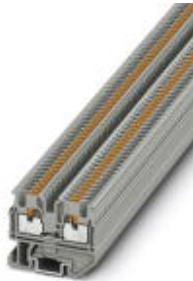
Mini-Durchgangsklemme, Anschlussart: Push-in-Anschluss, Anzahl der Anschlüsse: 2, Querschnitt: 0,14 mm 2 - 1,5 mm 2 , AWG: 26 - 14, Breite: 3,5 mm, Farbe: grau, Montageart: NS 15
