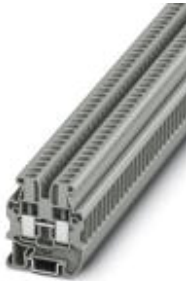
Mini-Durchgangsklemme, Anschlussart: Schraubanschluss, Anzahl der Anschlüsse: 2, Polzahl: 1, Querschnitt: 0,2 mm 2 - 4 mm 2 , AWG: 24 - 12, Breite: 5,2 mm, Farbe: grau, Montageart: NS 15
