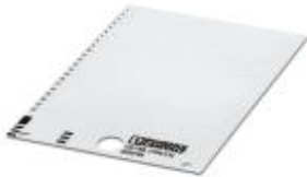
Marker für Klemmen, Karte, weiß, unbeschriftet, beschriftbar mit: THERMOMARK PRIME, THERMOMARK CARD, Montageart: Kleben, Schriftfeldgröße: 104 x 3,8 mm
