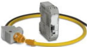
Set bestehend aus 2 Komponenten: dem 1A-Messumformer und einer Rogowski-Spule mit 300 mm Länge. Der Durchmesser der Messspule beträgt im installierten Zustand 95 mm. Die Rogowski-Spule dient zur AC-Strommessung von Stromschienen und Starkstromleitungen.
