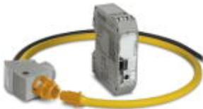
Set bestehend aus 2 Komponenten: 1A-Messumformer und einer Rogowski-Spule Länge 600 mm. Durchmesser der Messspule beträgt im installierten Zustand 190 mm. Die Rogowski-Spule dient zur AC-Strommessung von Stromschienen und Starkstromleitungen.
