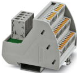
VARIOFACE-Modul, mit zwei Potenziialschienen (P1, P2) zur Potenzialverteilung, zur Montage auf NS 35-Tragschienen. Modulbreite: 67,3 mm
