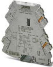
Universell-konfigurierbarer 4-Wege-Trennverstärker, mit Schaltausgang und steckbarer Anschluss-technik zur galvanischen Trennung von Analogsignalen. Konfigurierbar über DIP-Schalter oder mittels Software. Schraubanschlusstechnik, Standardkonfiguration.
