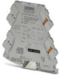
Universell-konfigurierbarer Temperaturgrenzwertschalter mit zwei Transistorausgängen für den Anschluss von 2-, 3-, 4-Leiter Widerstandsthermometern und Thermoelementen. Konfigurierbar über DIP-Schalter oder Software, Push-in-Anschlussstechnik
