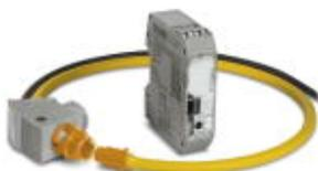
Set bestehend aus 2 Komponenten: dem 1A-Messumformer und einer Rogowski-Spule mit 450 mm Länge. Der Durchmesser der Messspule beträgt im installierten Zustand 140 mm. Die Rogowski-Spule dient zur AC-Strommessung von Stromschienen und Starkstromleitungen.
