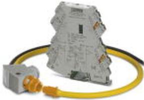
Set bestehend aus einem 4-Wege-Trennverstärker mit Schraubanschlusstechnik und einer Rogowski-Spule mit 300 mm Länge / 95 mm Durchmesser zur AC-Strommessung auf Stromschienen und Starkstromleitungen. Ausgangsseitig gibt der Trennverstärker 8 unterschiedliche Normsignale aus und verfügt über einen Schaltausgang.
