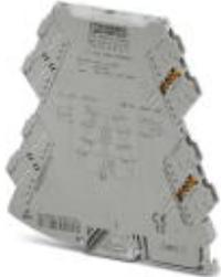
3-Wege-Trennverstärker mit steckbarer Anschluss Technik zur galvanischen Trennung von Analogsignalen. Eingangssignal: 0 ... 10 V, Ausgangssignal: 0 ... 20 mA, Push-in-Anschluss Technik
