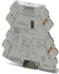
Analog-Frequenzwandler mit Grenzwertfunktionalität und steckbarer Anschluss-technik zur Umsetzung von Normsignalen in Frequenz- oder PWM-Signale. Konfigurierbar über DIP-Schalter oder mittels Software. Push-in-Anschluss-technik, Standardkonfiguration.
