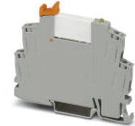
Vormontiertes Relaismodul mit Schraubanschluss, bestehend aus: Relaissockel mit Auswerfer und Leistungskontaktrelais. Kontaktausführung: 1 Schließer. Eingangsspannung: 12 V DC
