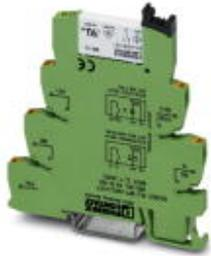
PLC-INTERFACE für Eingabefunktionen, bestehend aus Grundklemme PLC-BPT.../SEN mit Push-in-Anschluss und steckbarem Miniaturrelais mit Mehrlagen-Goldkontakt, zur Montage auf Tragschiene NS 35/7,5, 1 Schließer, Eingangsspannung 24 V DC
