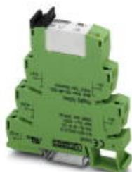
PLC-INTERFACE, bestehend aus Grundklemme PLC-BPT.../21-21 mit Push-in-Anschluss und steckbarem Miniaturrelais mit Leistungskontakt, zur Montage auf Tragschiene NS 35/7,5, 2 Wechsler, Eingangsspannung 120 V AC/DC
