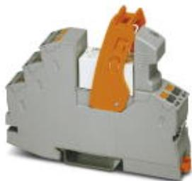
Vormontiertes Relaismodul mit Push-in-Anschluss, bestehend aus: Relaissockel, Leistungskontaktrelais, steckbarem Anzeige-/ Entstörmodul und Haltebügel. Kontaktausführung: 2 Wechsler. Eingangsspannung: 12 V DC
