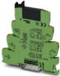
PLC-INTERFACE, bestehend aus Grundklemme PLC-BPT.../21 mit Push-in-Anschluss und steckbarem Miniatur-Solid-State-Relais, zur Montage auf Tragschiene NS 35/7,5, 1 Schließer, Eingang: 48 V DC, Ausgang: 3-33 V DC/3 A
