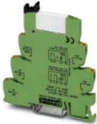
PLC-INTERFACE, bestehend aus Grundklemme PLC-BPT.../21 mit Push-in-Anschluss und steckbarem Miniaturrelais mit Mehrlagen-Goldkontakt, zur Montage auf Tragschiene NS 35/7,5, 1 Wechsler, Eingangsspannung 120 V AC/110 V DC
