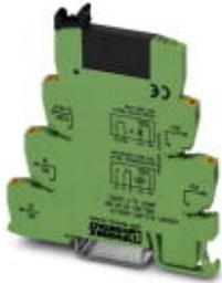
PLC-INTERFACE, bestehend aus Grundklemme PLC-BPT.../21 mit Push-in-Anschluss und steckbarem Miniatur-Solid-State-Relais, zur Montage auf Tragschiene NS 35/7,5, 1 Schließer, Eingang: 230 V AC/220 V DC, Ausgang: 3-48 V DC/100 mA
