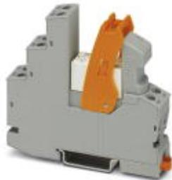
Vormontiertes Relaismodul mit Schraubanschluss, bestehend aus: Relaissockel, Mehrlagenkontaktrelais, steckbarem Anzeige-/ Entstörmodul und Haltebügel. Kontaktausführung: 2 Wechsler. Eingangsspannung: 24 V DC
