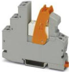
Vormontiertes Relaismodul mit Schraubanschluss, bestehend aus: Relaissockel, Leistungskontaktrelais, steckbarem Anzeige-/ Entstörmodul und Haltebügel. Kontaktausführung: 1 Wechsler. Eingangsspannung: 230 V AC
