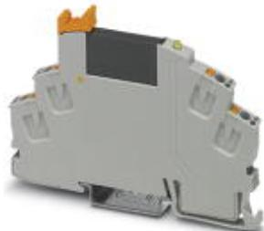
Vormontiertes Solid-State-Relaismodul mit Push-in-Anschluss, bestehend aus: Relaissockel mit Auswerfer und steckbarem Miniatur-Solid-State-Relais. Eingangsspannung: 24 V DC. Ausgang: 24-253 V AC/0,75 A
