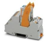
Vormontiertes Relaismodul mit Push-in-Anschluss, bestehend aus: Relaissockel, Leistungskontaktrelais mit zusätzlicher Hartvergoldung und Haltebügel. Kontaktausführung: 4 Wechsler. Eingangsspannung: 24 V DC
