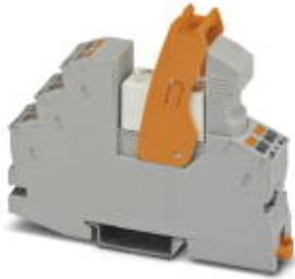
Vormontiertes Relaismodul mit Push-in-Anschluss, bestehend aus: Relaissockel, Leistungskontaktrelais, steckbarem Anzeige-/ Entstörmodul, Haltebügel. Kontaktausführung: 1 Schließer. max. Einschaltstrom bis 130 A peak, 80 A (20 ms) Eingangsspannung 24 V DC
