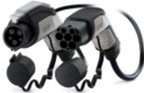
Mobile AC-Ladeleitung mit Fahrzeug-Ladestecker und Infrastruktur-Ladestecker, mit Verriegelungsmöglichkeit für Bügelschloss, mit Schutzkappen, Typ 1, Typ 2, IEC 62196-2, SAE J1772, 32 A / 250 V (AC), Designlinie C-Line, Kabel: 5 m, schwarz, gerade, Steckgesicht: schwarz, Griffbereich: grau
