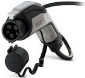
AC-Ladeleitung mit Fahrzeug-Ladestecker, offenes Leitungsende, mit Verriegelungsmöglichkeit für Bügelschloss, mit Schutzkappe, Typ 1, IEC 62196-2, SAE J1772, 32 A / 250 V (AC), Designlinie C-Line, Kabel: 5 m, schwarz, gerade, Steckgesicht: schwarz, Griffbereich: grau
