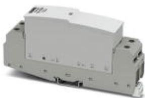
Steckbarer Blitzstromableiter, gem. Typ 1 / Class I, mit integrierter stoßstromfester Sicherung, für 1-phasige Stromversorgungsnetze mit kombiniert verlegtem PE und N in einem Leiter (L1, PEN).
