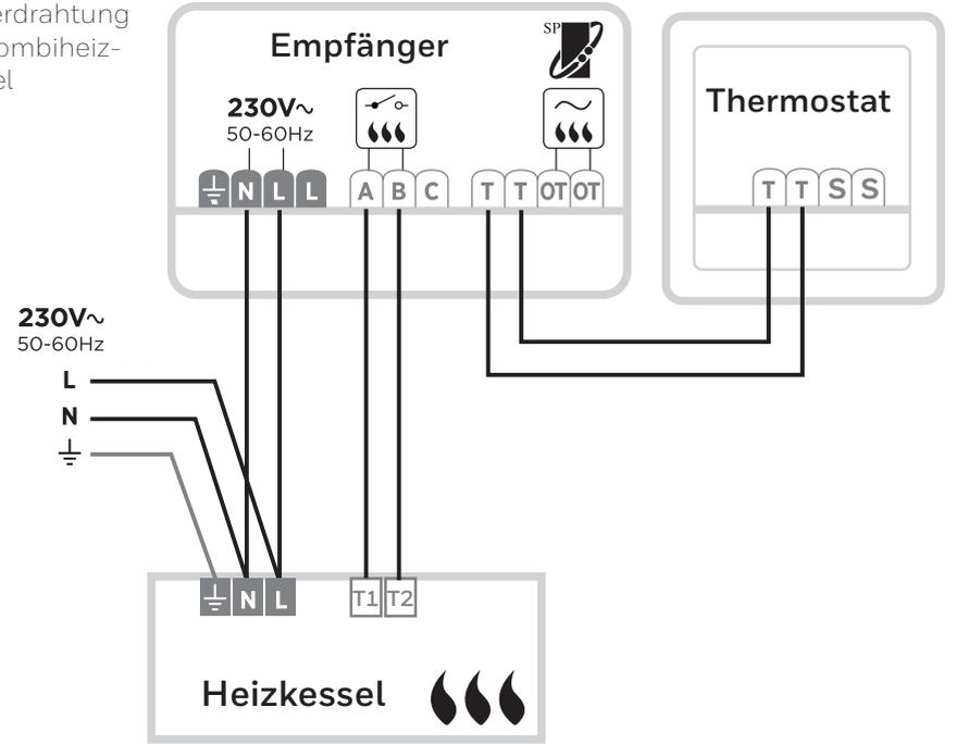
C) Verdrahtung für OpenTherm-Heizkessel
