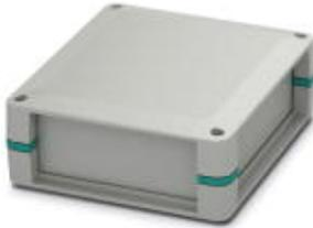
Komplettgehäuse für Leiterplatten, flexibel positionierbar; Beinhaltet Gehäusehalbschalen, Seitenwände geschlossen, Klebedome zur Platinenbefestigung, Schrauben für Gehäuse und Platinenbefestigung; Gehäusefarbe lichtgrau mit Eckenlegern türkis-grün
