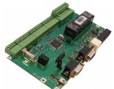
Interface-Modul zur Automatensteuerung
