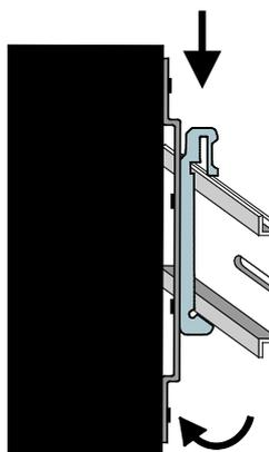
Abbildung 8: Entfernen von Tragschiene
