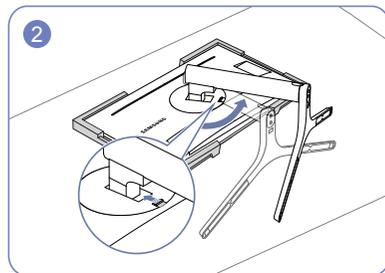
Drücken Sie die Taste nach oben und halten Sie sie gedrückt. Drehen Sie die Halterung für den Standfuß der Anzeige 10° im Gegenuhrzeigersinn.
