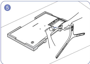
Halten Sie das Gerätegehäuse wie in der Abbildung gezeigt mit der Hand fest. Schieben Sie den montierten Standfuß in Pfeilrichtung (siehe Abbildung) in das Gerätegehäuse hinein.
