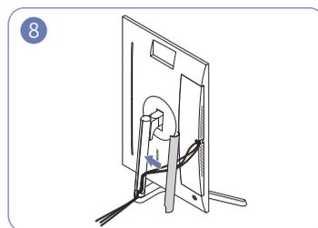
Decken Sie die LINKE ABDECKUNG DER STANDFUSS-HALTERUNG ab.
