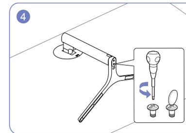
Drehen Sie die Befestigungsschraube unten am Standfuß, um sie zu lösen.
