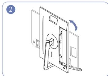
Drehen Sie das Gerät in die höchste Position.
