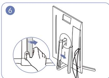
Öffnen Sie die LINKE ABDECKUNG DER STANDFUSS-HALTERUNG und drehen Sie den offenen Teil nach unten.
