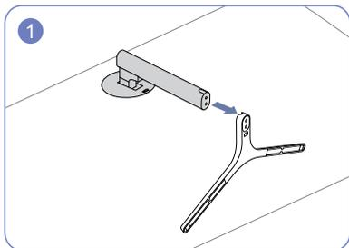
Setzen Sie den Standfußanschluss in der Richtung in den Standfuß, die in der Abbildung gezeigt ist.
