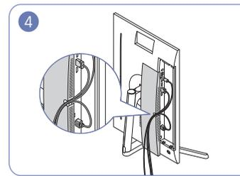
Ordnen Sie die Kabel entlang der Biegungsneigung der Kabel und ziehen Sie die Kabel aus den Vertiefungen der HINTEREN NEBENABDECKUNG.
