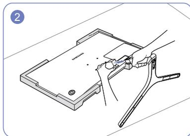
Um den Standfuß vom Monitor abzunehmen, stellen Sie sicher, dass Sie mit einer Hand auf den unteren Teil des Monitors drücken, und ziehen Sie dann mit der anderen Hand am Standfuß und schwenken Sie ihn zur Seite wie in der Abbildung gezeigt.
