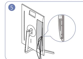
Decken Sie die HINTERE NEBENABDECKUNG ab. Richten Sie beim Anbringen der HINTEREN NEBENABDECKUNG zuerst sechs Lamellen der HINTEREN NEBENABDECKUNG nach den unteren Öffnungen der HINTEREN ABDECKUNG aus.
