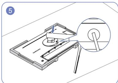
Platzieren Sie die Halterung für den Standfuß der Anzeige gemäß der Position der Befestigungselemente auf dem Gerät.
